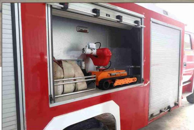
**Le MRX est un Mini Robot d'Extinction dont le format lui permet de trouver sa place dans le casier d'un fourgon !**
