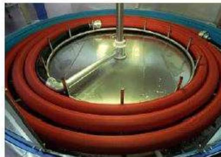
3) Epreuve : la table d'épreuve avec le tuyau sous pression reste mobile et facilite le contrôle visuel du tuyau.
