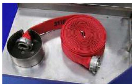
6) Enroulement en double automatique avec séchage par aspiration. Le tuyau se déplace essentiellement sur la tranche facilitant grandement le lavage et l'évacuation des impuretés ainsi que l'évacuation de l'eau de lavage.
