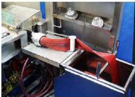
1) Quatre à six tuyaux en trempage, raccorder le tuyau au bras de fixation et démarrer la séquence de lavage
